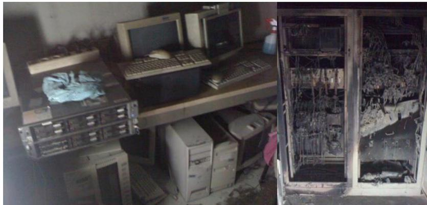
Gambar 5. Kebakaran pada *main* PDU pada ruang *server* di cabang Denpasar
