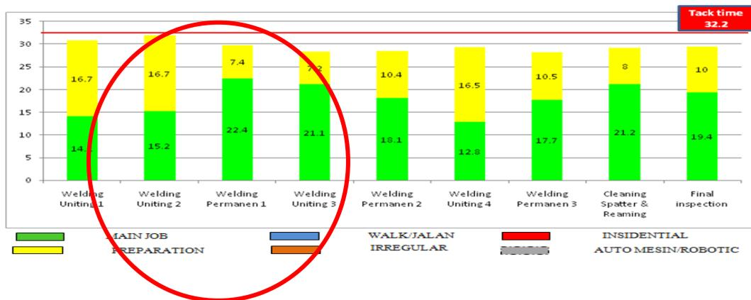
Gambar 11. Grafik *Cycle Time* pada Stasiun Kerja *Welding Permanent 1*, *Welding Uniting 1*, dan *Welding Permanent 2*
