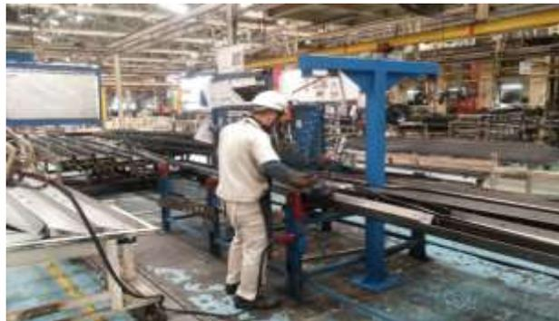
Gambar 2. Pemasangan inner pada Side Rail
