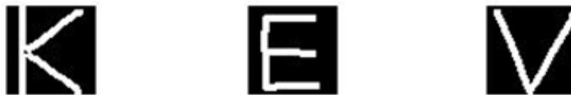
Gambar 5. Hasil *edge detection* yang dilasi dengan SE  $2 \times 2$
