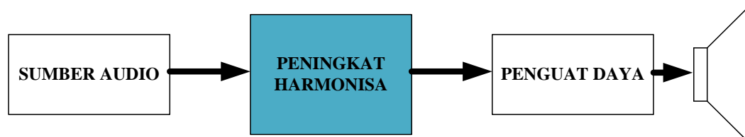
Gambar 1. Diagram blok konsep dasar peningkat harmonisa
